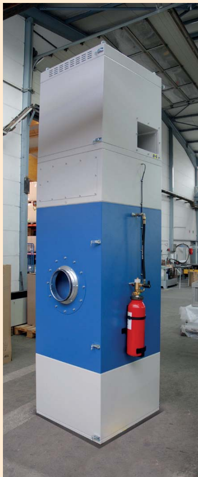
Automatische Lösung mit Hilfe eines Sprengschlauches
