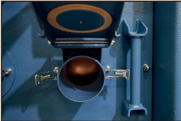
Frontanschlüsse für bis zu 6 Schläuche
