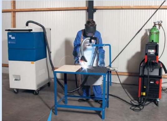
Anwendungsbeispiel: CARTMASTER MV mit Saugschlauch und Trichterdüse
