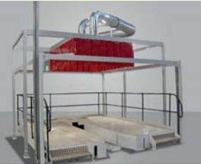
*Spezial-Absaughaube mit Lamellen bei Roboterabsaugung*
