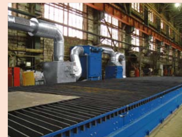
Stół do cięcia termicznego z systemem centralnym ZPF 9H i odbijaczem iskier
