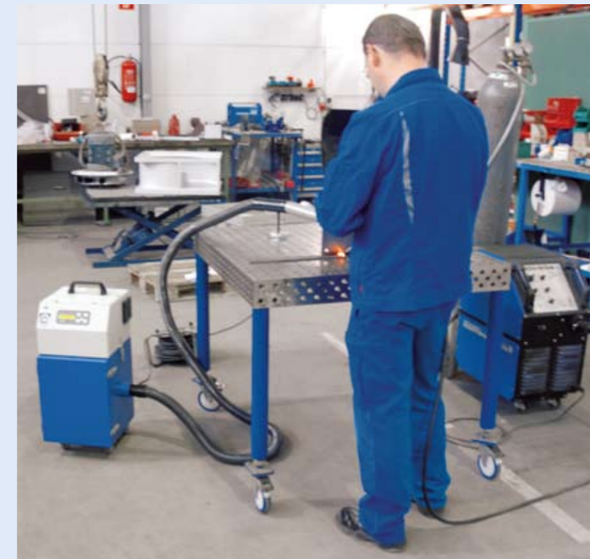
Przykład zastosowania: wersja z turbiną bezobrotową z przewodem węzowym i dyszą odciągową
