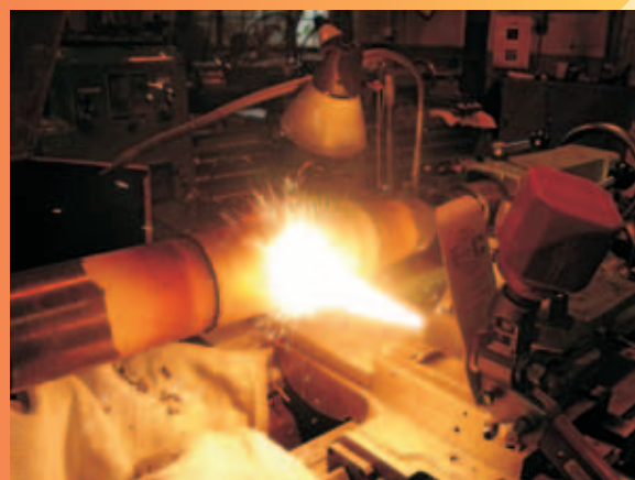
Odbudowa powierzchni wału szlifierki metodą natrysku proszkowego
