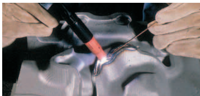
1) Dysza gazowa - 2) Gaz osłonowy - 3) Spoiwo w postaci pręta - 4) Jeziorko spawalnicze - 5) Spoina - 6) Materiał bazowy
