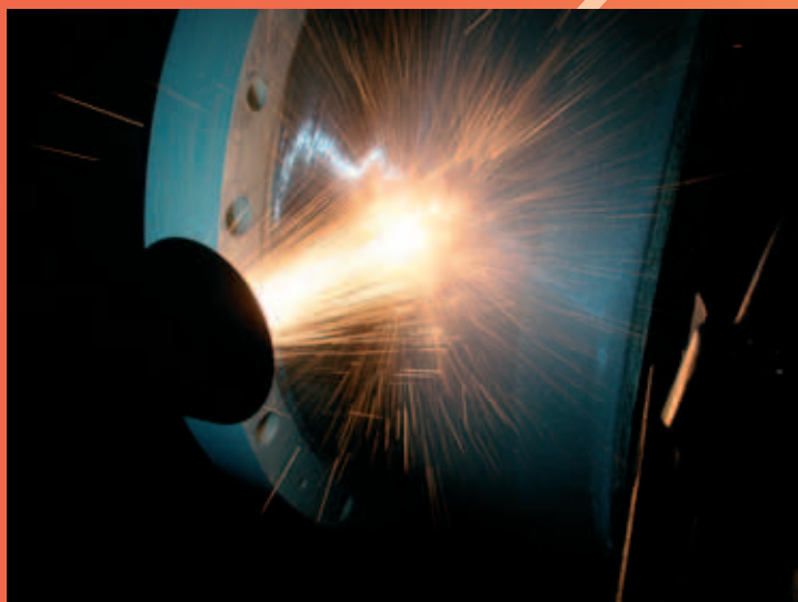
Metalizacja łukowa tulei łożyskowej
