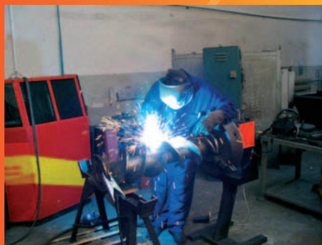
Napawanie metodą MIG/MAG
