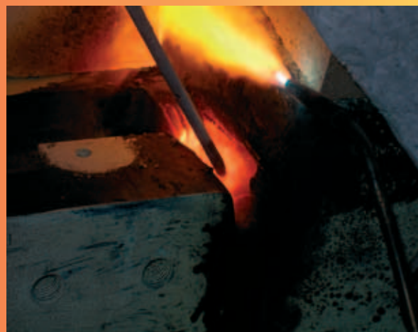
Odbudowa powierzchni wału szlifierki metodą natrysku proszkowego
