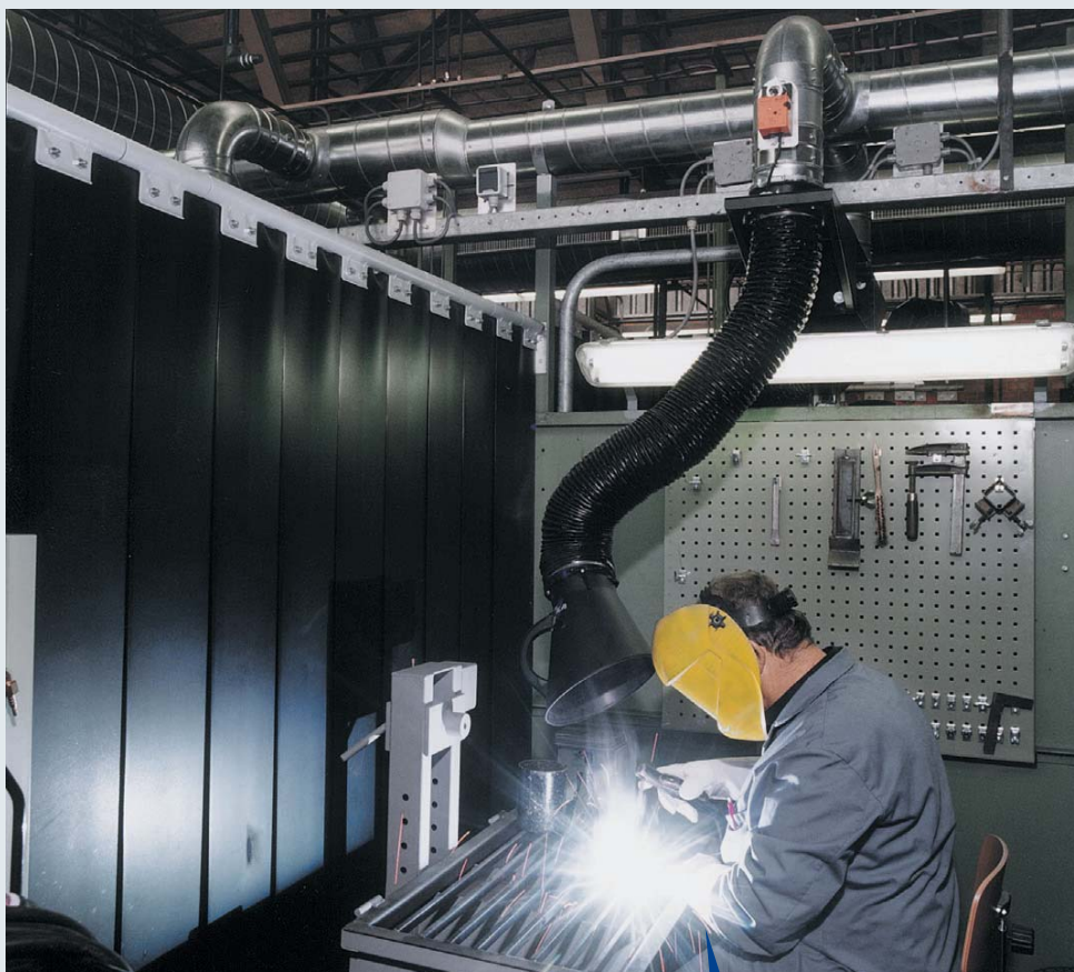
Przykład zastosowania: ramię teleskopowe w kabynie spawalniczej
