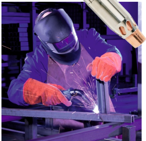
Uchwyt RAB GRIP włączony układ odciągu dymów spawalniczych
