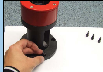
Fot.2. Montaż śrub w przyrządzie
