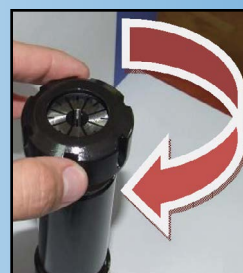
Fot.6. Wstępne skręcenie tulejki z oprawką
