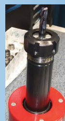
Fot.8. Narzędzie zamontowane w oprawie
