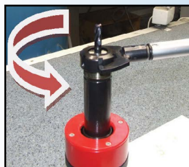
Fot.10. Odkręcanie nakrętki kluczem dynamometrycznym
