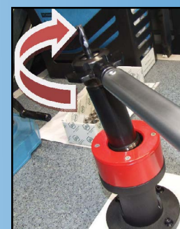
Fot.9. Dokręcanie nakrętki kluczem dynamometrycznym
