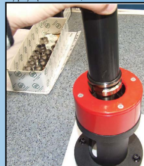
Fot.4. Wsadzanie oprawy w przyrząd
