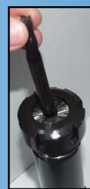
Fot.7. Umieszczanie narzędzia w oprawie
