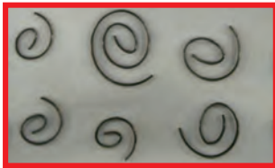
GND Type (GG Type Chipbreaker)
