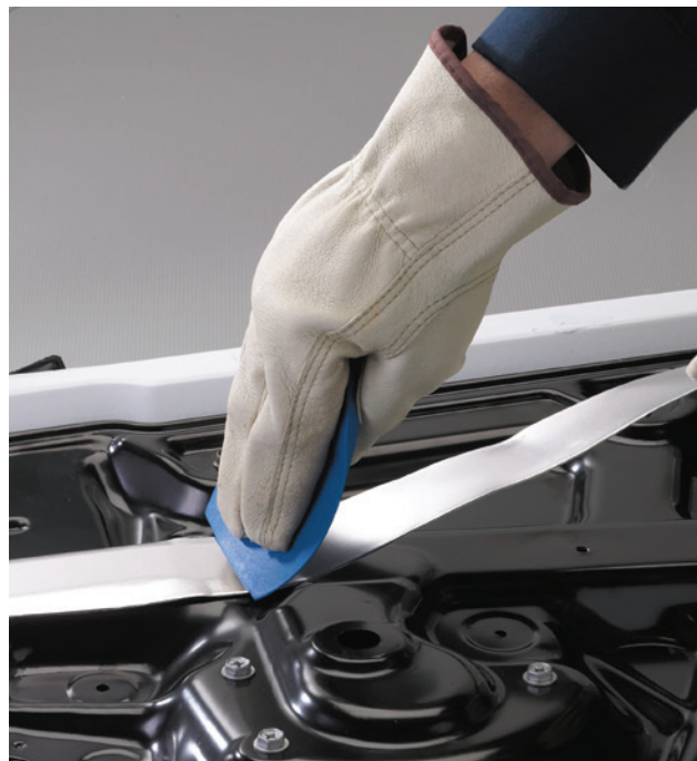
Taśma wyciszająca 3M™ 2552 nałożona przy użyciu rakli dociskowej 3M™ PA-1 Wiper na wewnętrzną stronę drzwi samochodu skutecznie wycisza i zmniejsza wibracje po nałożeniu już na 10% powierzchni. Akryl o ulepszonej formule naniesiony na bardzo miękką folię aluminiową przekształca energię wibracji na pomijalne ciepło ulegające rozproszeniu.
