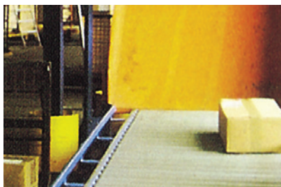
Pudełka z tekstury falistej łatwiej zsuwają się po rynnie wyłożonej wytrzymałymi na ścieranie taśmami 3M wykonanymi z UHMW-PE.
