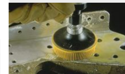
Usuwanie powłok malarskich
