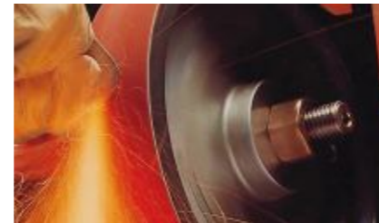
Obróbka zgrubna stali nierdzewnej
