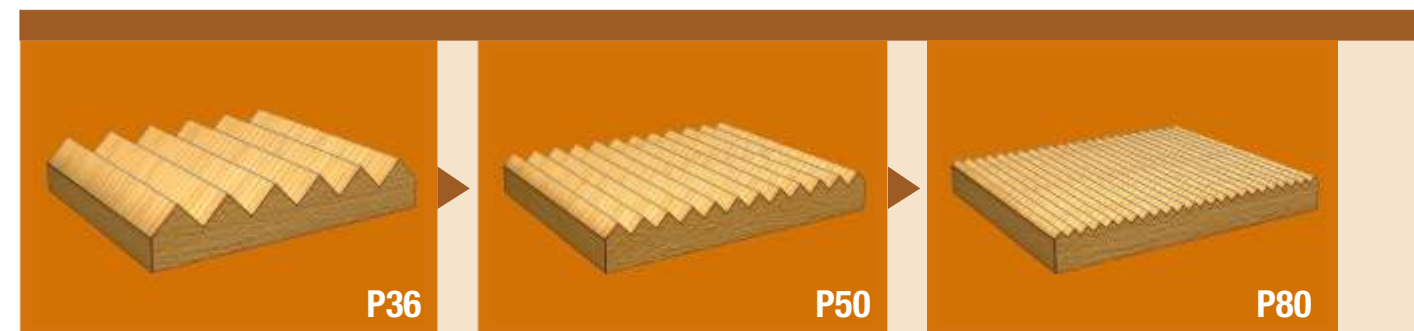
Prawidłowa sekwencja granulacji - powierzchnia jest jednorodnie wyszlifowana
