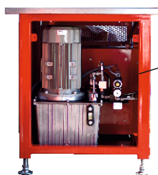
wbudowany zasilacz hydrauliczny o mocy 4 kW
