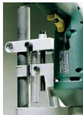
ogranicznik głębokości wiercenia
