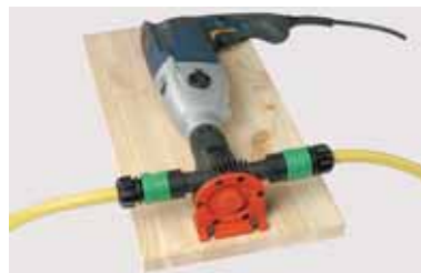
nasza rada: pompa + wiertarka + deska
