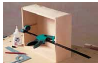
prosta przebudowa do funkcji rozpieraka
