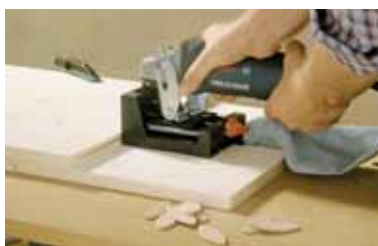
połączenie za pomocą płytek
