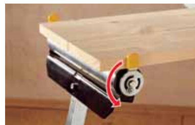
podparcie rolką pozwala na łatwe podawanie obrabianego materiału w kierunku zgodnym z kierunkiem obróbki materiału
