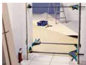
prosta przebudowa do funkcji rozpieraka
