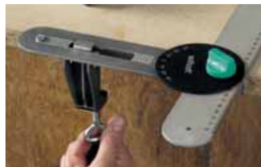
możliwość przykręcenia do blatu stołu lub obrabianego materiału
