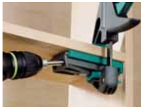
Z użyciem Undercover Jig wiercimy precyzyjne otwory w desce...
