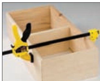
Ściskanie klejonego elementu
