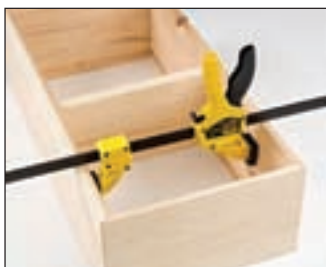
Rozpieranie klejonego elementu
