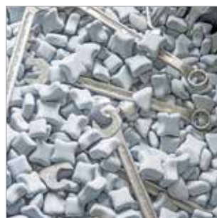
Starannie wykończona, przyjazna dla dłoni powierzchnia dzięki typowym dla STAHLWILLE zaokrąglonym wykończeniom
