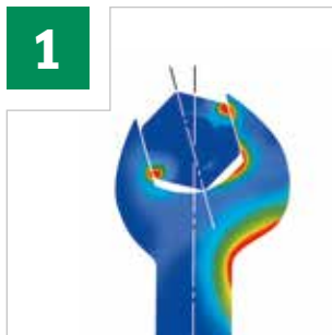
Osie obciążenia w standardowych kluczach
