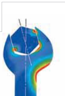
Osie obciążenia w standardowych kluczach
