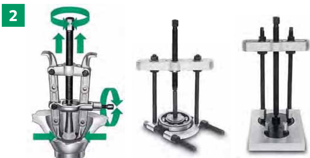
Zasada działania ściągacza dwuramiennego
