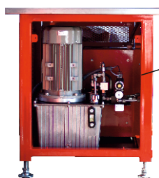
wbudowany zasilacz hydrauliczny o mocy 3 kW
