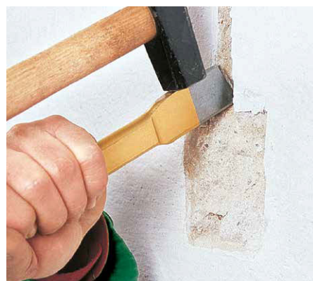
Elektrikerschlitzmeißel Electrician's slotting chisels
