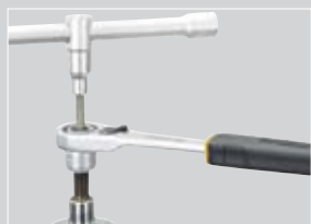
Przy montażu amortyzatorów wstrząsowych (najczęściej 22 mm).
