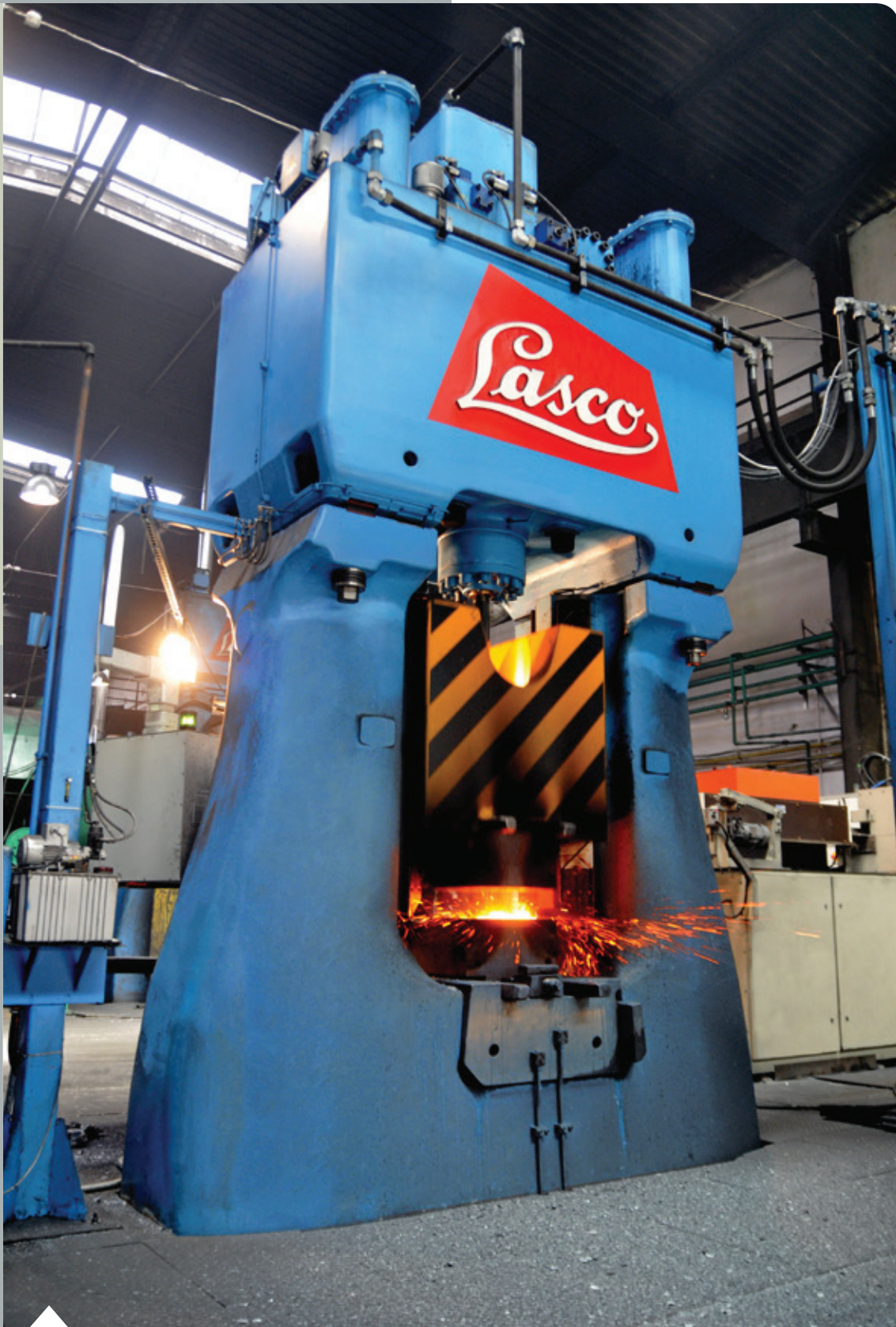
Młot hydrauliczny firmy LASCO HO-U 400 z wyrzutnikiem odkuwek
