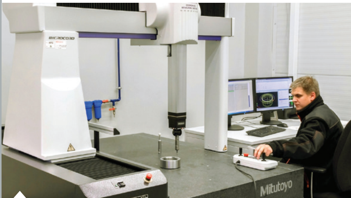
Sprawdzanie wymiarów odkuwek na współrzędnościowej maszynie pomiarowej MITUTOYO
