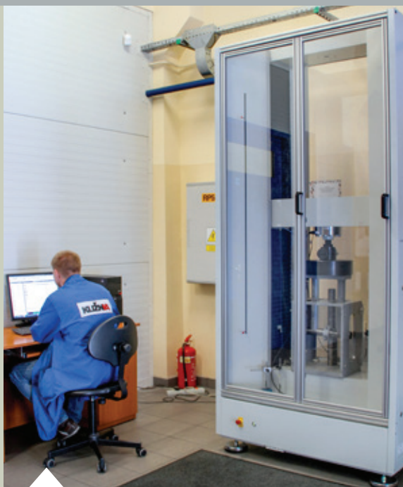
Uniwersalna maszyna wytrzymałościowa TEST 114.200 kN
