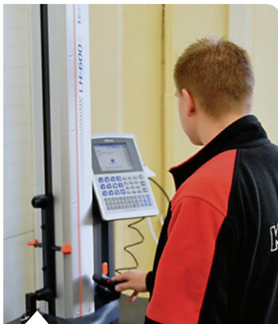
Sprawdzanie wymiarów odkuwek na maszynie pomiarowej MITUTOYO
