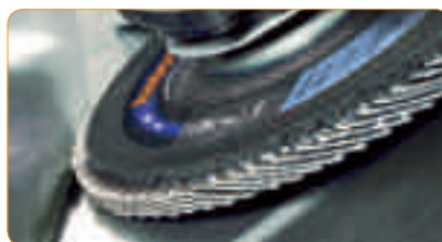
Nieekonomiczne, gdyż duża część materiału szlifowanego pozostała nieużyta
