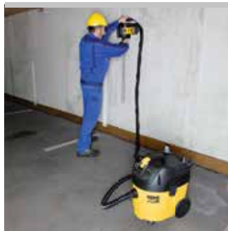
Certyfikowane odkurzacze i odpylacz do zbierania pyłów niebezpiecznych dla zdrowia wg EN 60335-2-69.
