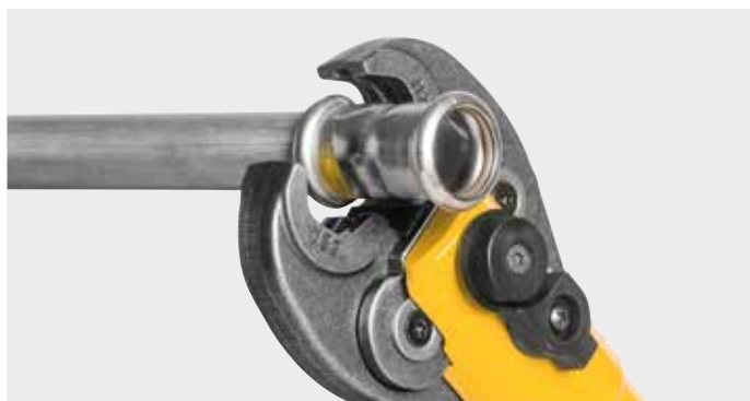
Cęga zaciskowa REMS z 2 obrotowymi mono-blokowymi szczękami.
