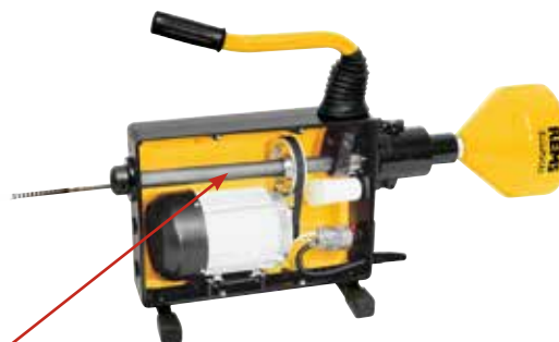
Przelotowe, zamknięte wrzeciono napędowe chroni silnik i przekładnię przed brudem i wodą.
