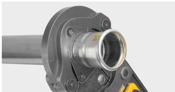
Pierścień zaciskowy REMS (PR-3S) z 3 segmentami zaciskowymi ułożyskowanymi odchylnie na przegubowym pierścieniu w celu zaciśnięć wielkogwintowych o dużych wymaganiach. Optymalne zaciskanie poprzez promieniowo sterowany ruch segmentów zaciskowych, z cęgą pośrednią.
