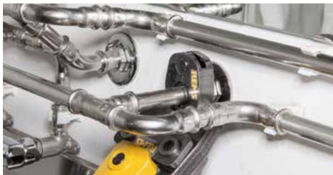
Pierścień zaciskowy REMS 45° (PR-2B) z 2 szczękami zaciskowymi do wykonywania zaciśnięć w trudno dostępnych miejscach, z cęgą pośrednią.
