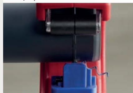
Przeznaczony nawet do krótkich odcinków rur ok. 10 mm. Podczas fazowania powstają wióry.
