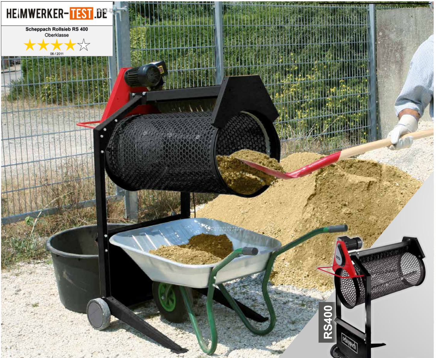
Durch die doppelseitige Aufhängung der Siebtrommel mit Keilriemen, ist die Einwurfföffnung völlig frei.
