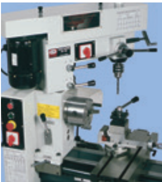
MOŻLIWOŚĆ OBROTU URZĄDZENIA FREZUJĄCEGO
