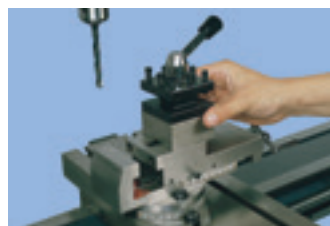
PO ZDEMONTOWANIU IMAKA MAMY DO DYSPOZYCJI IMADŁO
