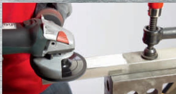
Przygotowanie do polerowania: przygotowanie materiału do polerowania za pomocą tarczy szlifierskiej Metabo Pyramid.
