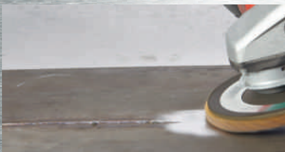
Zgrubne szlifowanie spoin spawalniczych: przy zastosowaniu niskoobrotowej szlifierki kątowej INOX i lamelowo-włókninowej tarczy szlifierskiej o dużej ziarnistości.
