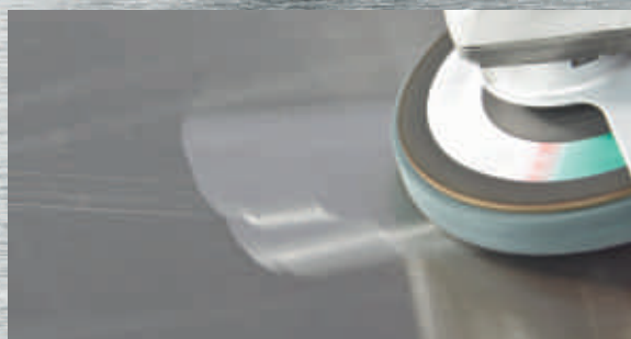
Usuwanie zadrapań: za pomocą niskoobrotowej szlifierki kątowej INOX oraz tarczy szlifującej ze sprasowanej włókniny.
