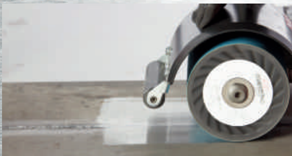
Zgrubne usuwanie materiału: za pomocą wałka rozprężnego uzbrojonego w pasy bezkońcowe o ziarnistości P60, P80 lub P120.
